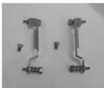
LGA775用取付クリップ (取り付け済み)
